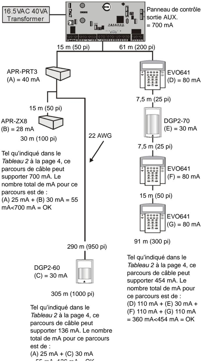
**!** Ne pas utiliser le même transformateur pour le panneau de contrôle et les blocs d'alimentation externes. Les modules ne doivent jamais être installés à plus de 914 m (3000 pi) du panneau.
