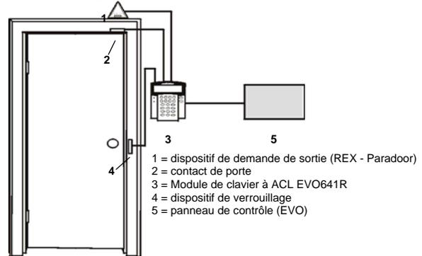
Figure 24 : Vue d'ensemble du contrôle d'accès
