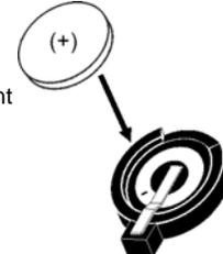
⚠ Après avoir remplacé la batterie, reprogrammer l'horloge du panneau de contrôle. Il y a danger d'explosion si la batterie est remplacée incorrectement. Remplacer uniquement avec une batterie du même type ou d'un type recommandé par le constructeur. Jeter les batteries usagées conformément aux instructions du fabricant.
