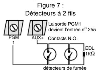
Note : Il est recommandé que les détecteurs de fumée soient connectés en une configuration en série.
