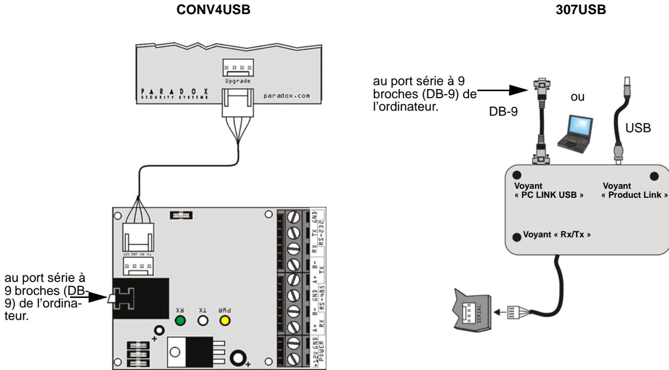
Figure 21 : Mise à niveau des claviers EVO641-EVO641R
