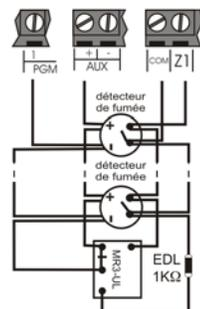
Note : Il est recommandé que les détecteurs de fumée soient connectés en une configuration en série.
